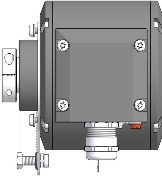
b) Entfernen Sie optional die Torxschrauben komplett, um das Stützblech zu wenden. Drehen Sie anschliessend die Torxschrauben wieder leicht ein.
