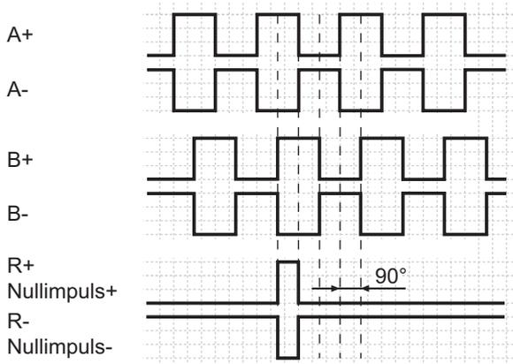
Abb. 7: Ausgangssignale bei positiver Drehrichtung
