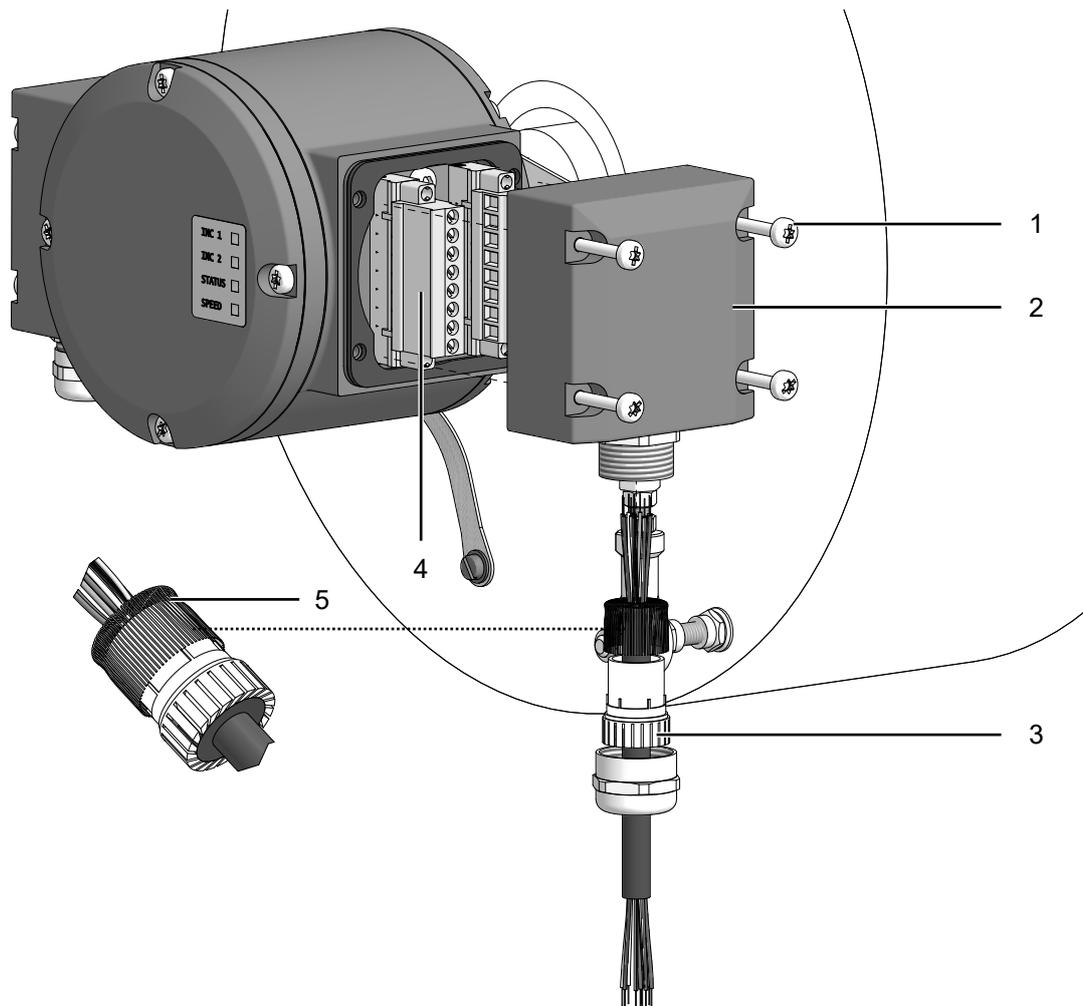
Abb. 8: Anschlusskabel anschliessen
