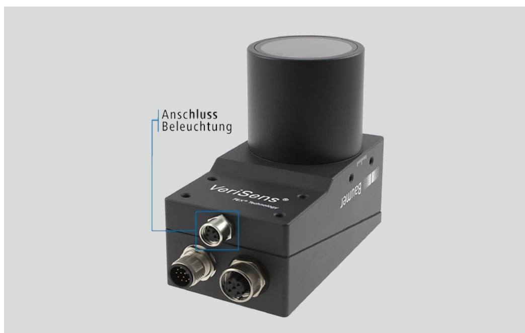
Direkter Anschluss der Beleuchtung an VeriSens® C-Mount über 4-poligen M8-Stecker.
